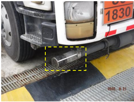
ภาพที่ 2.1-17 อุปกรณ์ป้องกันการเกิดประกายไฟ จากท่อไอเสียเครื่องยนต์
